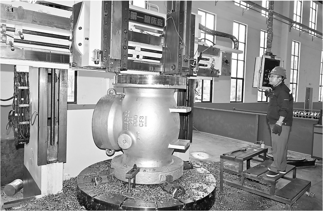
近日,位于政和经济开发区的福建美科机械有限公司生产车间内,工人正在对大型阀门进行精加工。该企业系上海美科阀门有限公司旗下子公司,是一家集科研、生产、加工、销售和服务于一体的科技型高端铸造企业,主要产品为泵、阀壳体、机器设备部件的砂铸及精密铸件等。今年预计产值可达1.5亿元。(罗光耀 曾大龙 摄)
