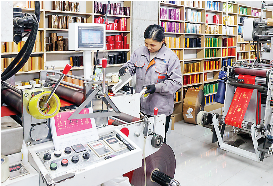
2月7日，在武夷山旺角包装文化创意园有限公司，工人在全新数码泡袋打印设备上作业。 该公司引进自动台式高速烫金机，上线数码泡袋打印工艺，实现制袋—打印—烫金一体化联动，每小时可精准烫印15600个泡袋，无版直印省却制版成本，满足武夷山中小茶企的定制需求，用专业工艺为茶香添彩。 (邱汝泉 摄)
