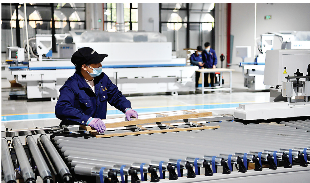
8日,在位于政和鹤林工业园区的福建政和中辉工贸有限公司新车间里,工人使用自动封边机对板材进行封边。中辉工贸是当地重点招商企业,总投资1.03亿元,今年4月初正式投产,主营竹木家居、家具产品、轻工工艺品等。企业引进全新智能化设备,提供设计、生产、销售一站式服务,产品畅销海外。(余长青摄)
