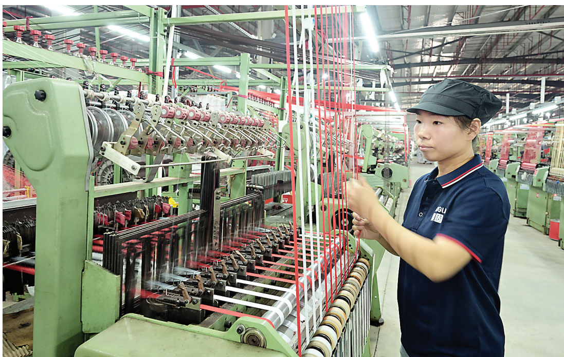
24日，在位于松溪循环经济产业园的福建奥固拉链制造有限公司车间，工人正在进行织带作业。奥固拉链制造有限公司设有智能化厂房、原料仓库及多条生产线，主营全系列拉链产品。生产环节采用智能装备与节能工艺，推行废弃物循环利用，依托“原液着色”技术减少印染环节与资源消耗，兼顾高效生产与绿色低碳发展。该公司入驻松溪循环经济产业园，补齐了当地新型轻纺产业短板，形成高效协同的产业闭环。目前公司首批设备已安装投产，第二批设备安装稳步推进。(罗光耀 摄)
