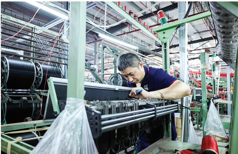
工人开展穿纱工序作业
