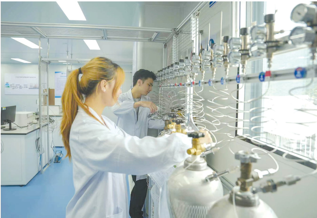
在国家碳计量中心(福建)温室气体高精度标定实验室内,技术人员进行气路检漏。(姜琳 吴建琼 摄)
