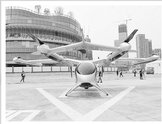
▲2月27日,停在深圳蛇口邮轮母港的5座eVTOL(电动垂直起降)航空器盛世龙。
