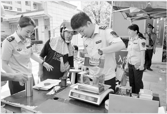
7月23日,南平市市场监管局和建阳区市场监管局联合开展电子计价秤专项整治行动,并组织技术机构工作人员现场对电子计价秤的计量标识、称量、偏载等项目开展检定。(谢红灿 邱国娟 摄)
