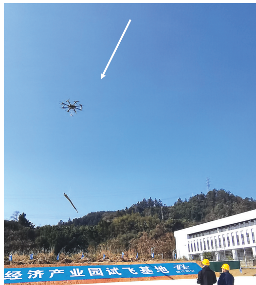
飞手正在操作重载无人机进行毛竹吊运作业
